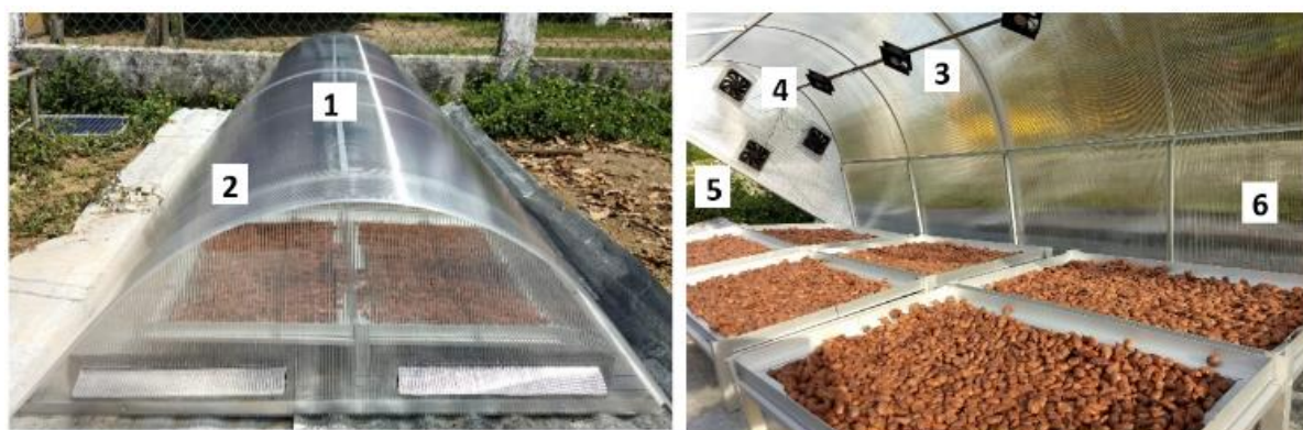
Figura 9: Estudo de projecto piloto de secagem de grãos de cacau mediante o uso de túneis de policarbonato em Tabasco, México (1. capa de policarbonato com proteção UV; 2. janelas que permitem a entrada de ar; 3. ventiladores para homogeneizar o calor interno; 4. exaustores; 5. porta-bandeja; e 6. bandejas) (Cerino & García, 2018)
