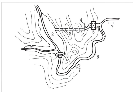
Figura B.7 Utilização de rápidos de torrentes ou quedas de água naturais
