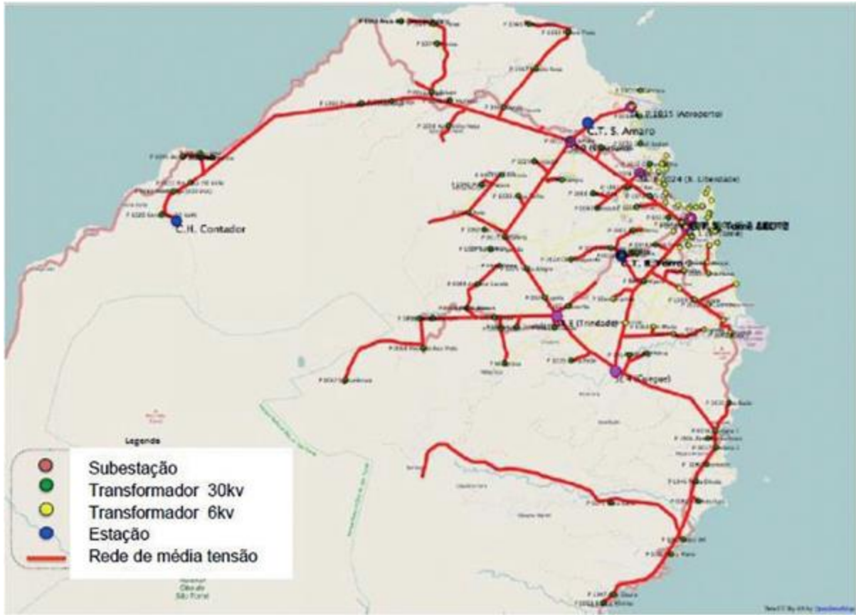
Figura 8: Rede de distribuição eléctrica de São Tomé (Fonte: Ricardo Energy & Environment, 2018)
