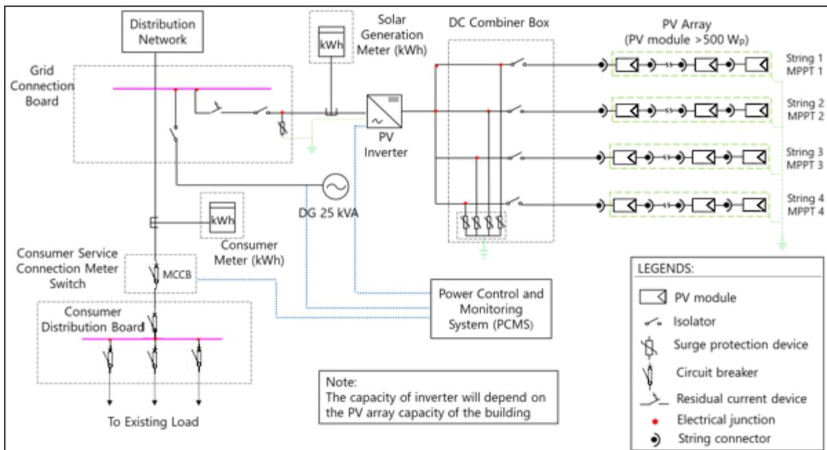
Figure 18: Single line diagram of rooftop PV system for Direção do Ensino Primário
