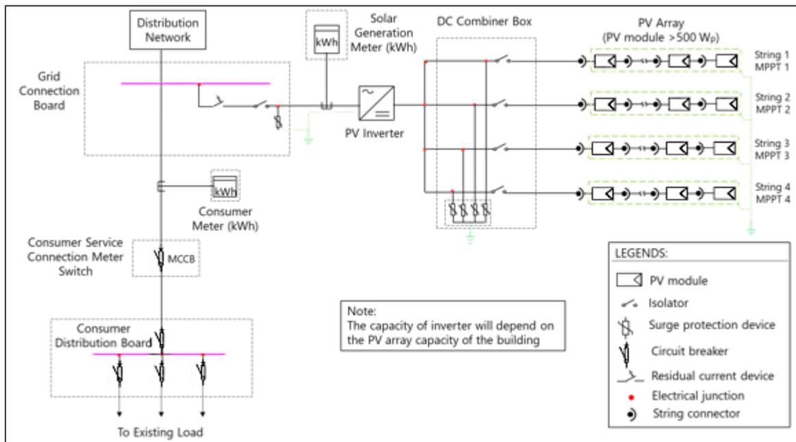
Figure 92: Single line diagram of PV system for Direção Regional De Ambiente E Conservação da Natureza Príncipe
